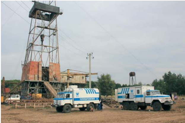
Рисунок 12. Каротажна техніка NADRA Group на свердловині (2011)
