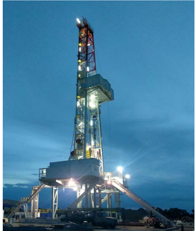
Рисунок 18. Бурова установка SL 2000T-AC-50H-3P-500T (вантажопідіймальність 454 м.т.) Полтава, 2019 рік Власник: «БК Укрбурсервіс»
