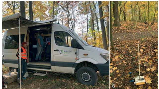
Рисунок 2. Проведення польових робіт. а – сейсмостанція Wireless Seismic RT System 2 б – польові модулі WRU на профілі
