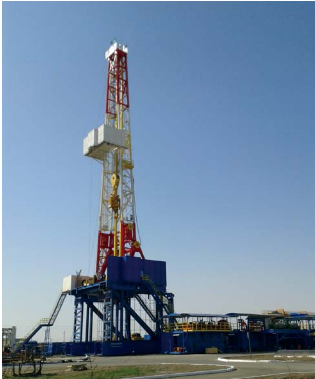
Рисунок 16. Бурова установка SL 2500T-AC-50H-3P-650T (вантажопідіймальність 590 м.т.) Казахстан 2015 рік Спільний проект з компанією «Жигермунайсервіс». Кінцевий замовник: «КазПетроДріллінг»
